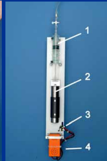
Balgrist-Prototypen für ein low-cost NPWT von Dominik Meyer (1970-2019)
